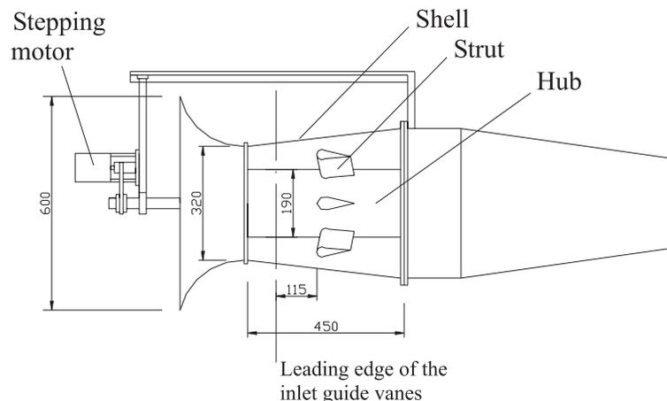
Fig. 1. Diffuser model.
