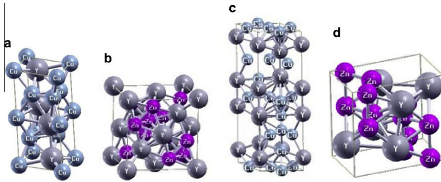
Fig. 1. Crystal structures of C14 (a), C15 (b) and C36 (c)  $AB_2$  type Laves phases and  $CeCu_2$  (d) type orthorhombic structure.
