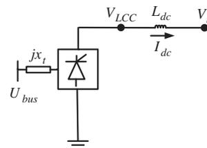
Fig. 2. LCC converter.
