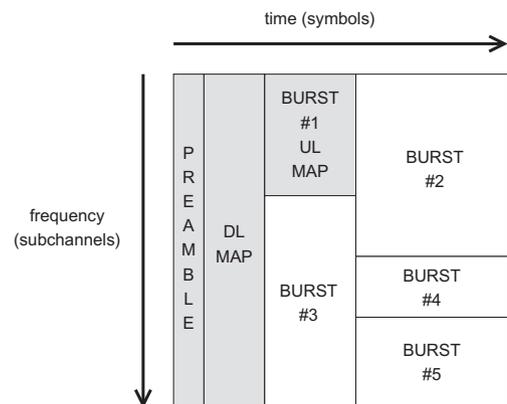
**Fig. 2.** IEEE 802.16e DL subframe structure.
