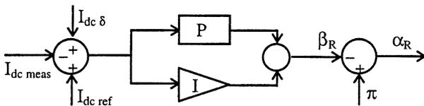
Fig. 2. Rectifier control.
