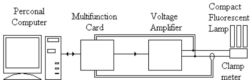
Fig. 1. Experimental apparatus.
